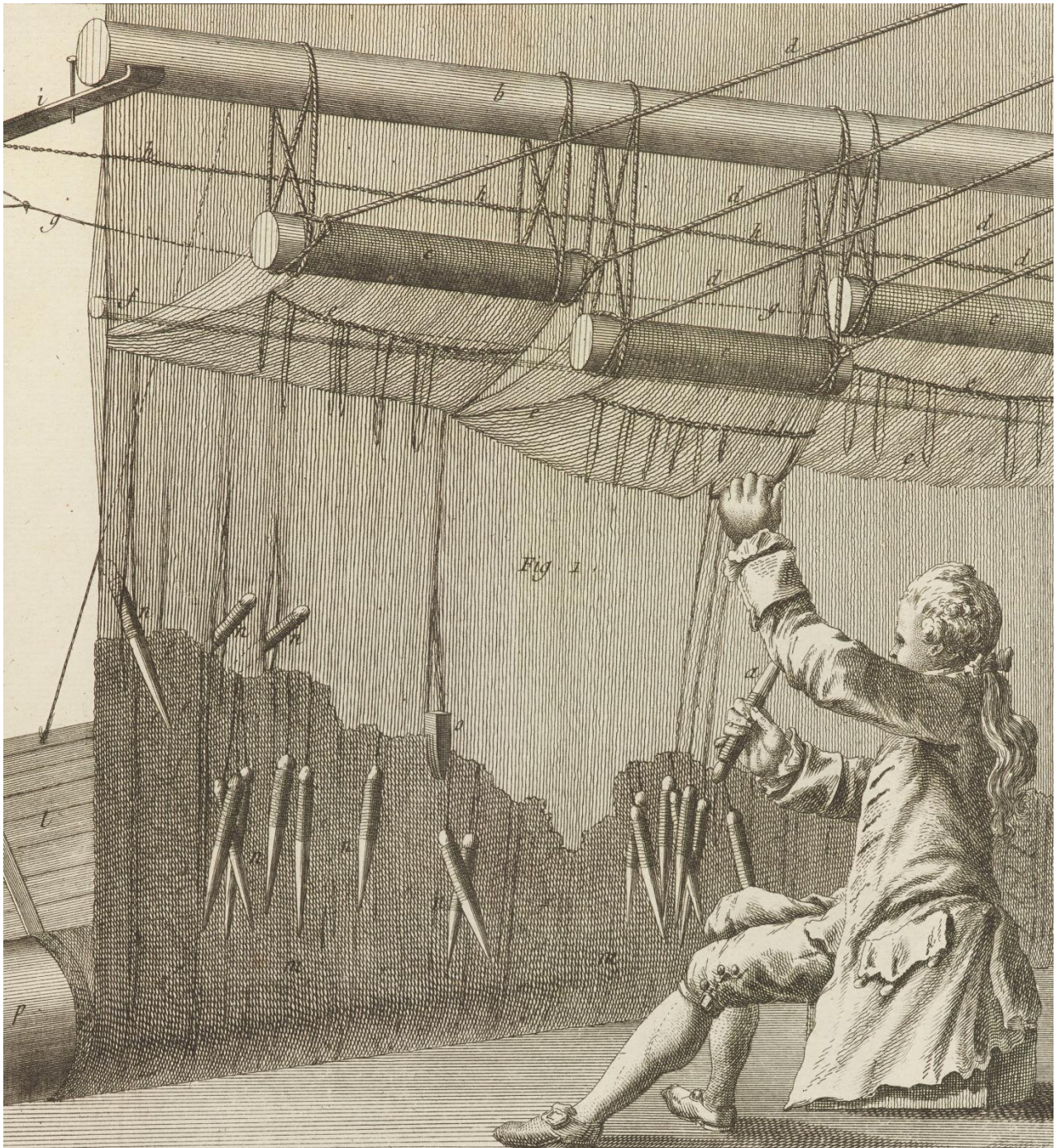
"Tapisserie de Haute Lisse des Gobelins, Attitude de l'Ouvrier pour commencer l'Ouvrage"(vol. 8 des planches de l'Encyclopédie par Diderot et d'Alembert, Paris, 1771.CMN) On distingue les ensouples, les lisses, les fils de chaîne et de trame, les broches.
